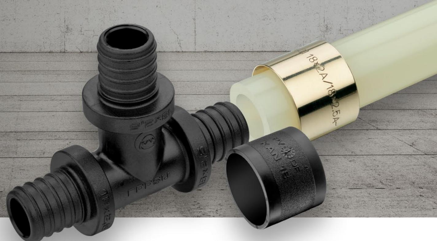
**Надеждност, постигната чрез уникално решение – самохерметизираща се връзка, без допълнителни О-пръстени. Фитинги, изработени от месинг CW617N или PPSU пластмаса могат да се комбинират с хомогенни тръби PE-RT и PE-X с вътрешна антидифузионна бариера (петслойни тръби).**
