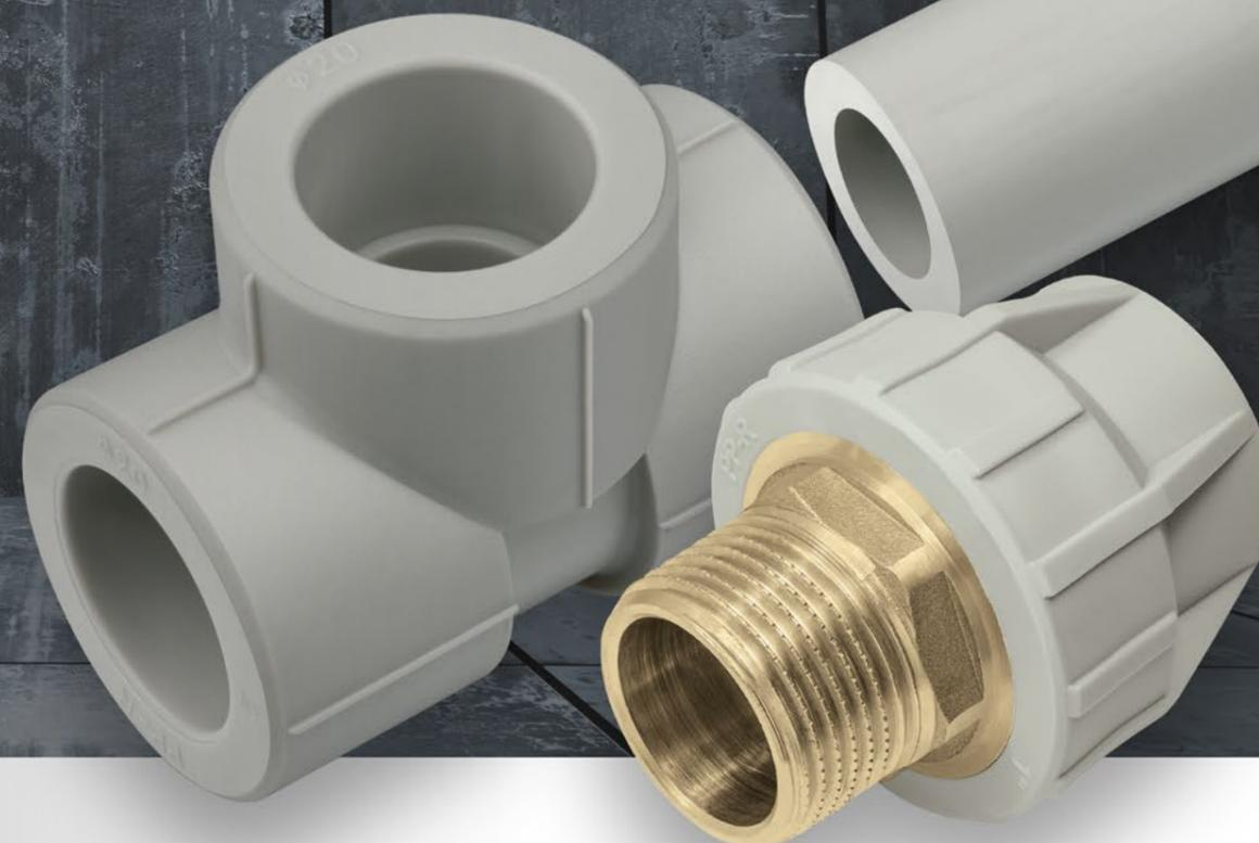
Системата се свързва чрез термично лепене на муфи (термична полифузия) с помощта на електрически лепачки. Техниката на термично лепене, благодарение на хомогенната връзка, гарантира изключителната херметичност и механичната здравина на инсталацията.
