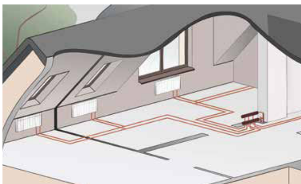
Колектор - система от тройници в отоплителна инсталация
