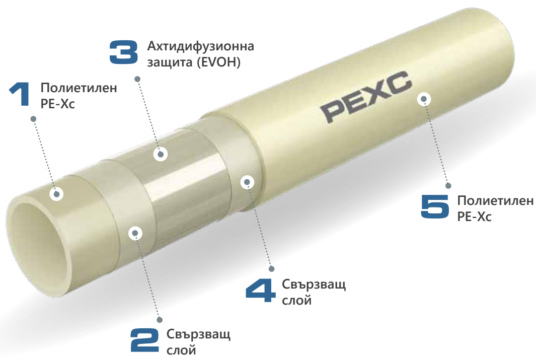
Фиг. 48. Дизайн на KAN-therm PEXC тръба с EVOH слой.
