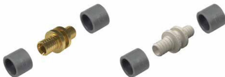
Фиг. 50. KAN-therm ultraLINE конектор за PEXC, PERT 2 and PERTAL 2 тръби, диаметри 14 × 2, 16 × 2,2, 20 × 2,8, 25 × 2,5 mm.
