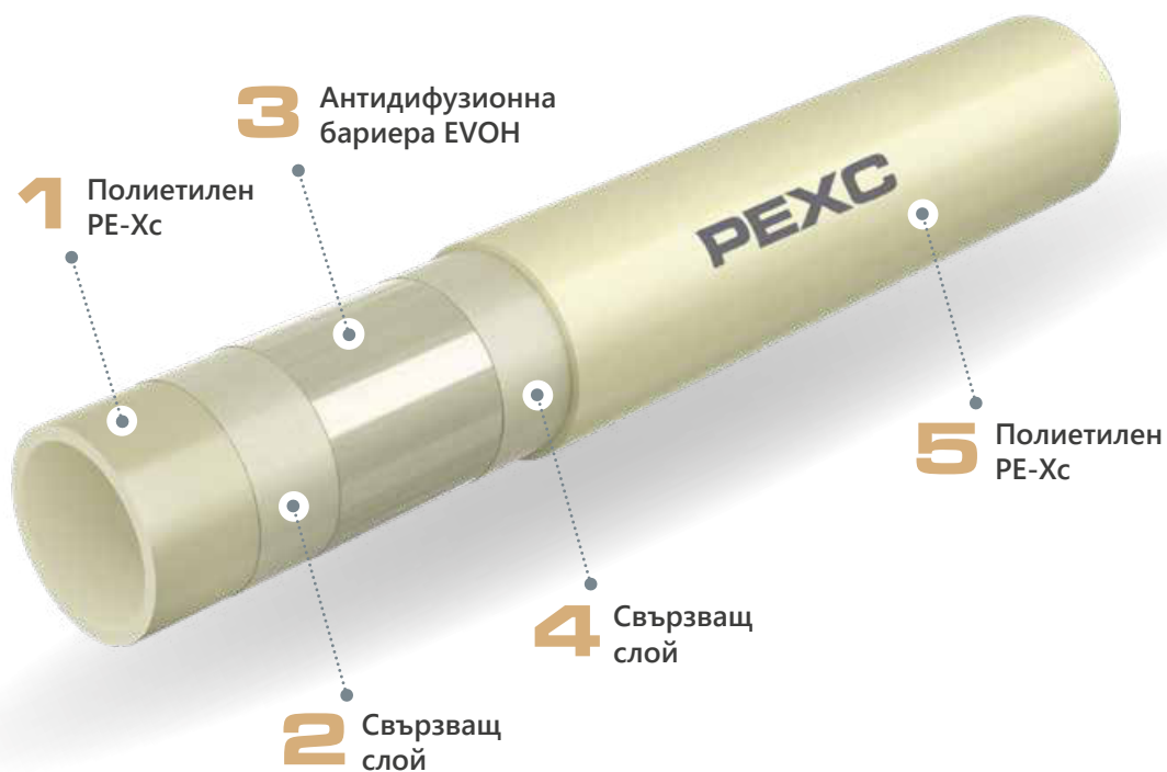
Напречно сечение на PEXC pipe с антидифузно покритие
