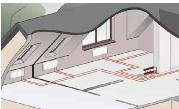
Колектор - система от тройници в отоплителна инсталация
