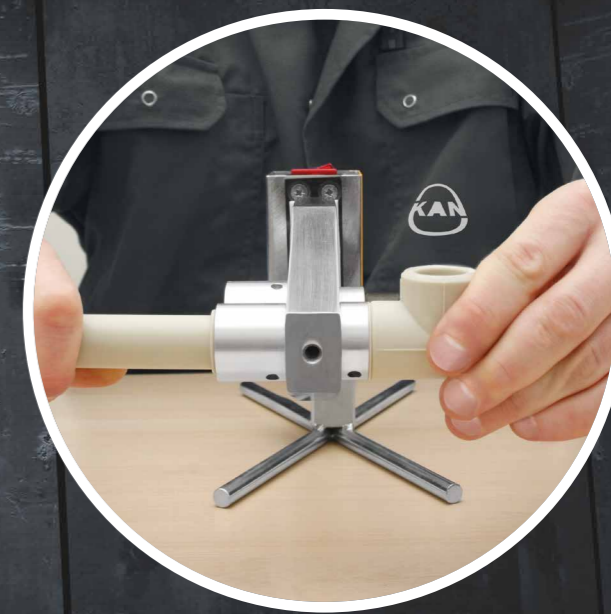
04 Загряване на тръбата и фитинга.
